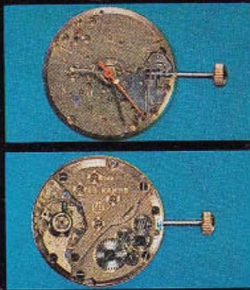
Калибр механизма 22 мм, 23 рубиновых камня, стальной анкерный ход, период колебания баланса 0,4 с, центральная секундная стрелка и противоударное устройство оси баланса, пружина из нержавеющей стали, продолжительность хода часов от одной полной заводки пружины 38 ч.
