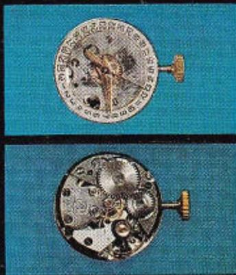
Калибър на механизма 18 мм, 17 рубинени камъка, стоманен анкерен ход, период на колебание на баланса 0,33 с, централна секундна стрелка, противоударно устройство на оста на баланса и календарно устройство, пружина от неръждаема стомана, продължителност на работа на часовника от едно пълно навиване – 40 ч.
